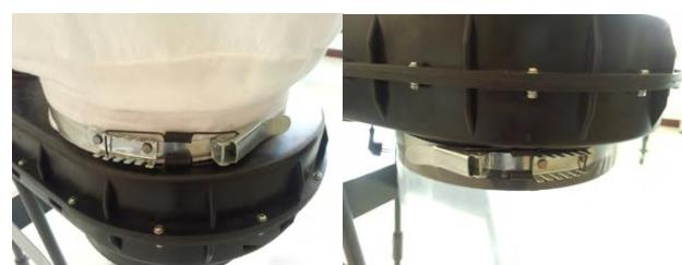
8. Absaugschlauch am Lüfterradgehäuse mit der Klemme befestigen.
