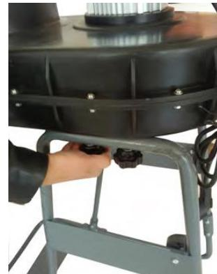
6. Filtersackhalterung am Lüfterradgehäuse montieren.
