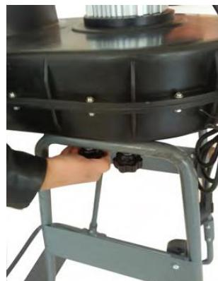
6. Installer le support du sac filtrant sur le logement du ventilateur.
