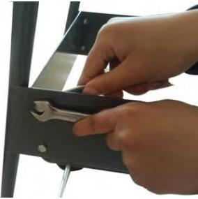
5. Das Lüfterradgehäuse mit den 4 Sternschrauben an den Seitenhalterungen montieren.
