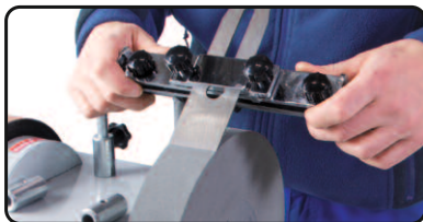
05-2054 Gabarit : Convient aux rabots et burins d'une largeur maximale de 70 mm et d'une épaisseur maximale de 6,5 mm
