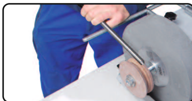
05-14809A Disque d'affûtage en cuir profilé : pour le dressage et le polissage intérieur des gouges tournantes et des pieds-de-biche
