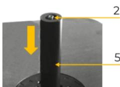
3. Faites glisser le rouleau de ponçage en caoutchouc (5) sur la broche (2)
